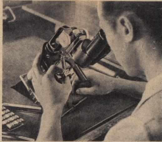
Die Polschuhe müssen haargenau eingerichtet werden; die Justierung erfolgt daher unter einer Binokularlupe
