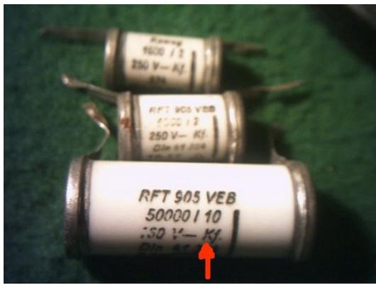
Kunststoffoliekondensatoren im Keramikrohr.
