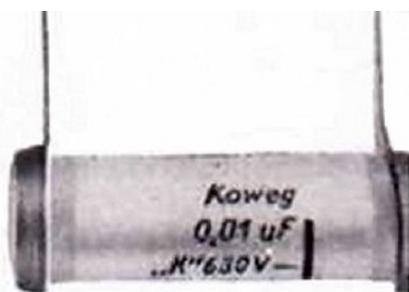
Papierkondensatoren im Keramikrohr, Ausführung k
